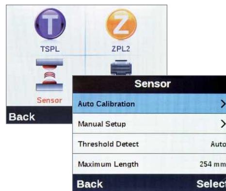
Schritt 2: Kalibrieren am LCD-Farbdisplay
